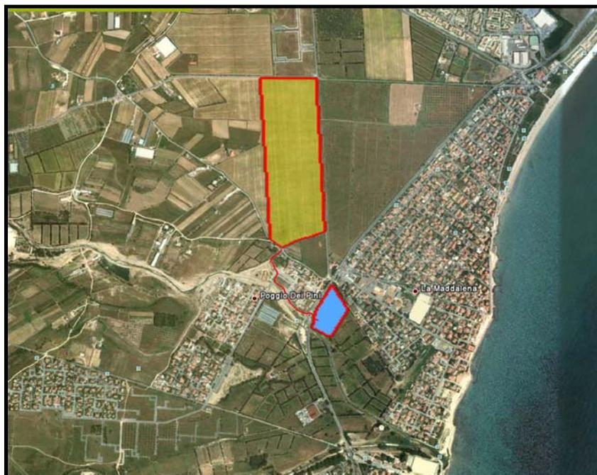
Figura 35 – Ubicazione dell'area di cantiere (azzurro), dell'area di stoccaggio (verde) e della viabilità di collegamento (rosso) secondo lo studio preliminare ambientale dell'ottobre 2010.
