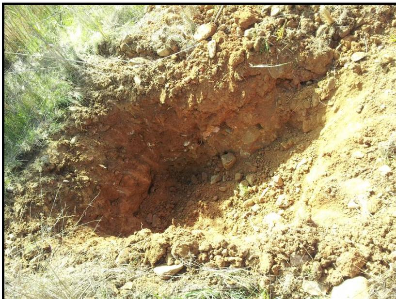
**Figura 54 – Realizzazione dello scavo e predisposizione al prelievo dal fondo (cava S.I.FRA.).**
