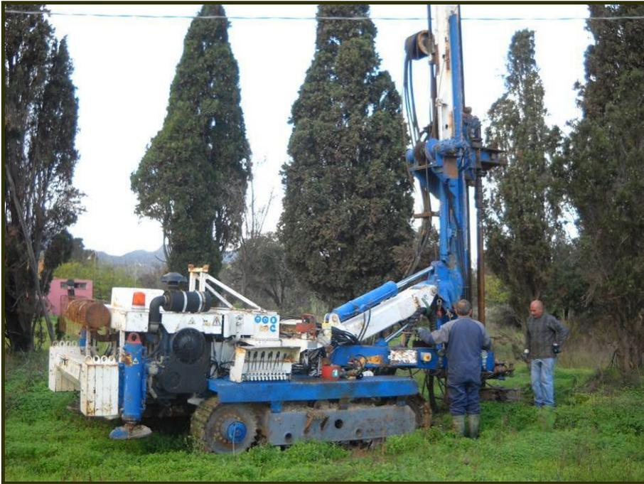
Figura 19 – Sonda idraulica impiegata.
