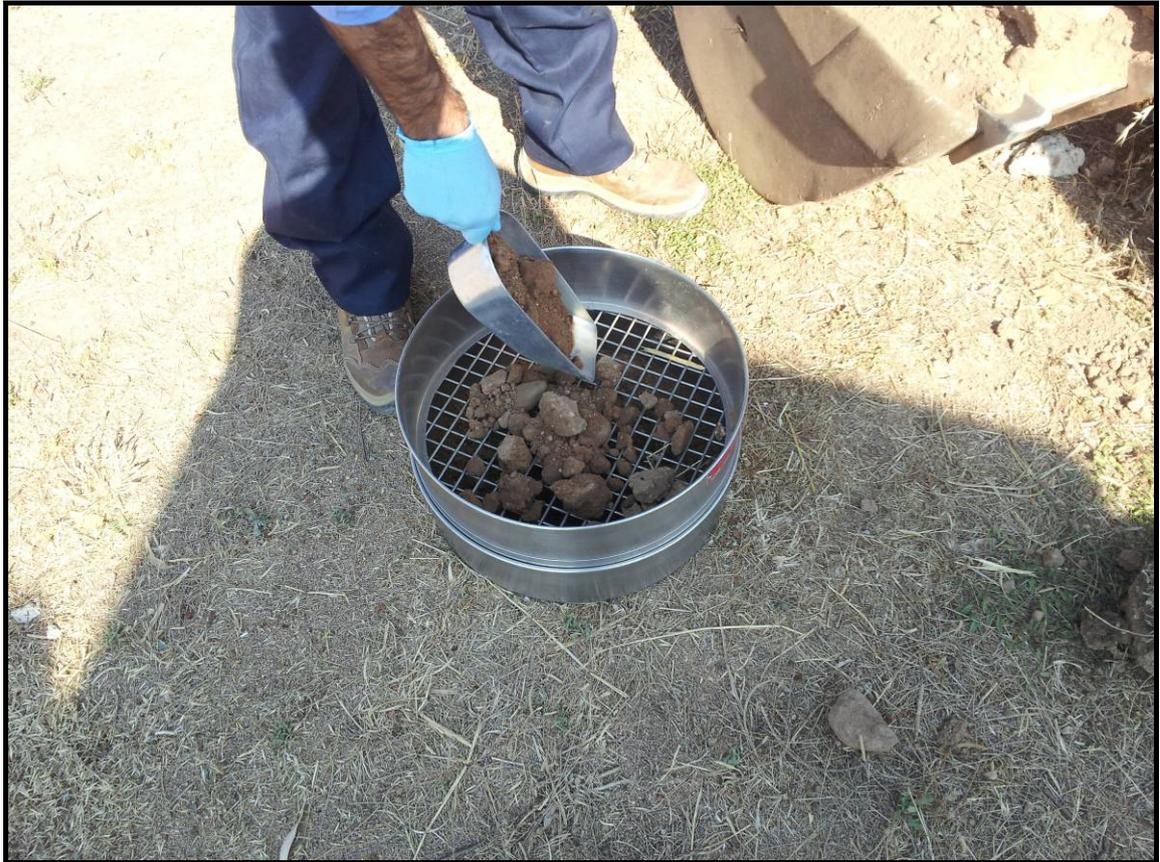
**Figura 22 – Setacciatura del campione da analizzare.**
